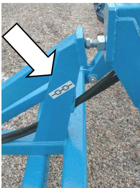
Dess. 12 - Marquage du point de prise sur le timon de la machine
