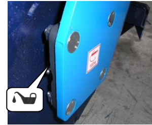
Dess. 16-fixation de l'essieu
