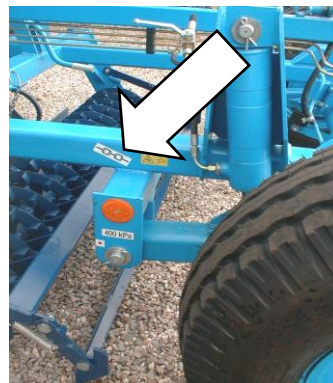
Dess.13 - Marquage du point de prise sur le cadre de la machine
